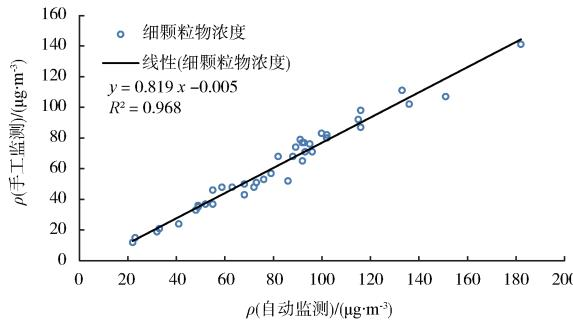
图3 自动监测与手工监测比对数据相关性
